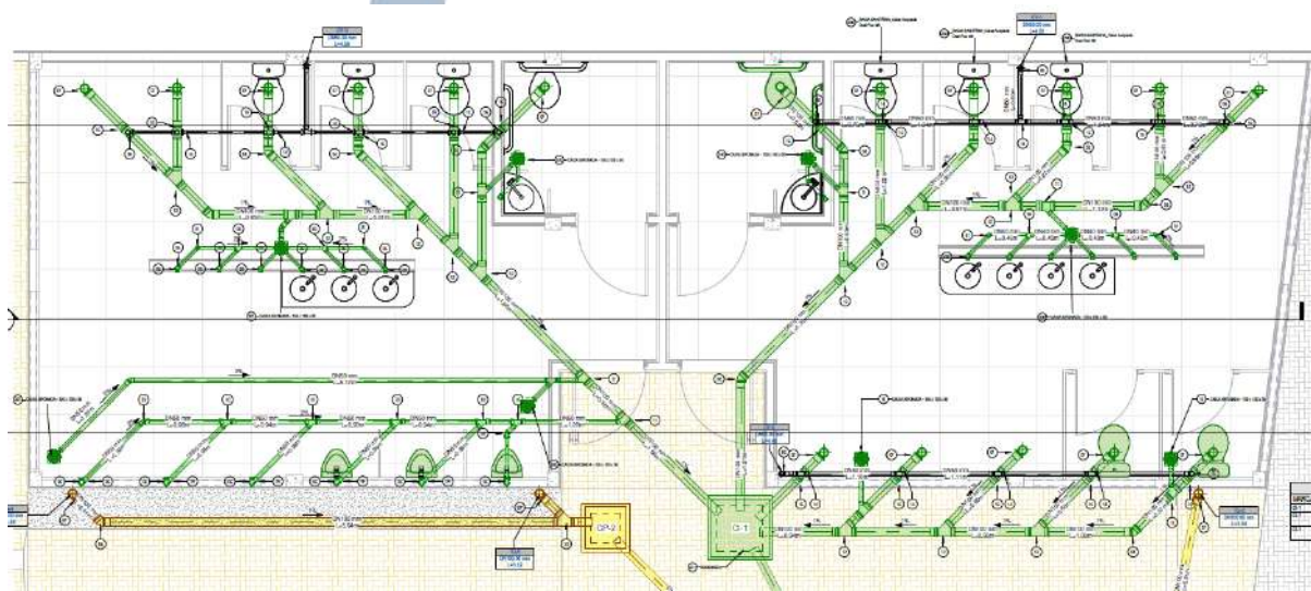
Figura 17 - Planta baixa de esgoto banheiros.
